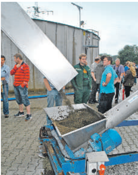
Beim Separieren von Schweinegülle mit einer Zentrifuge entsteht ein Feststoff mit durchschnittlich 29 % TS, in der 65 bis 80 % des P_2O_5 enthalten sind.
